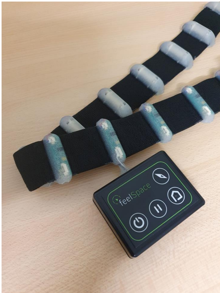
Per Ultraschallschweißverfahren hergestellter Demonstrator. Foto: feelSpace
