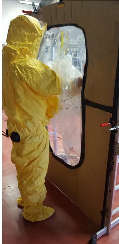
**Bild links:** Der Helfer schweißt vor Beginn des Einsatzes den peelbaren Folienschlauchstutzen im Brustbereich des Schutzanzuges zu, die Schweißnaht lässt sich aufgrund der innenseitigen Peelbeschichtung später wieder öffnen (Foto: DITF)
