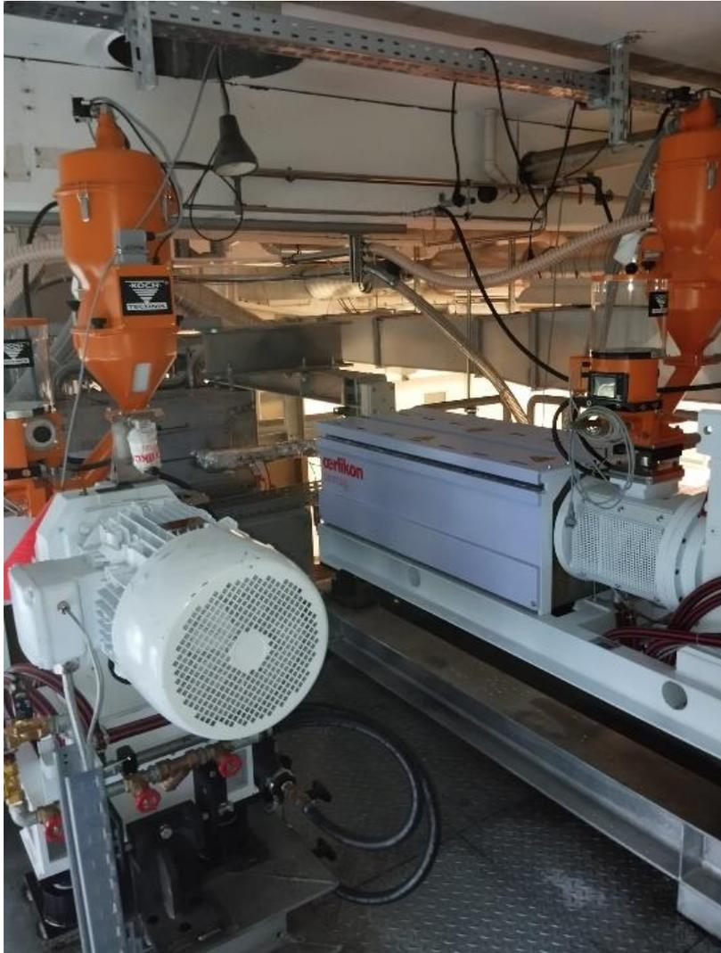
Pumpen und Extruder der Bikomponenten-BCF-Spinnanlage der Firma Oerlikon Neumag. Foto: DITF
