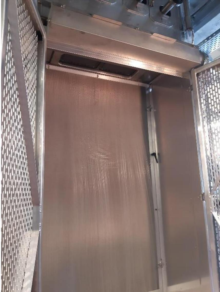
Der Spinnchacht der Bikomponenten-BCF-Spinnanlage der Firma Oerlikon Neumag mit den frisch extrudierten Fasern. Foto: DITF
