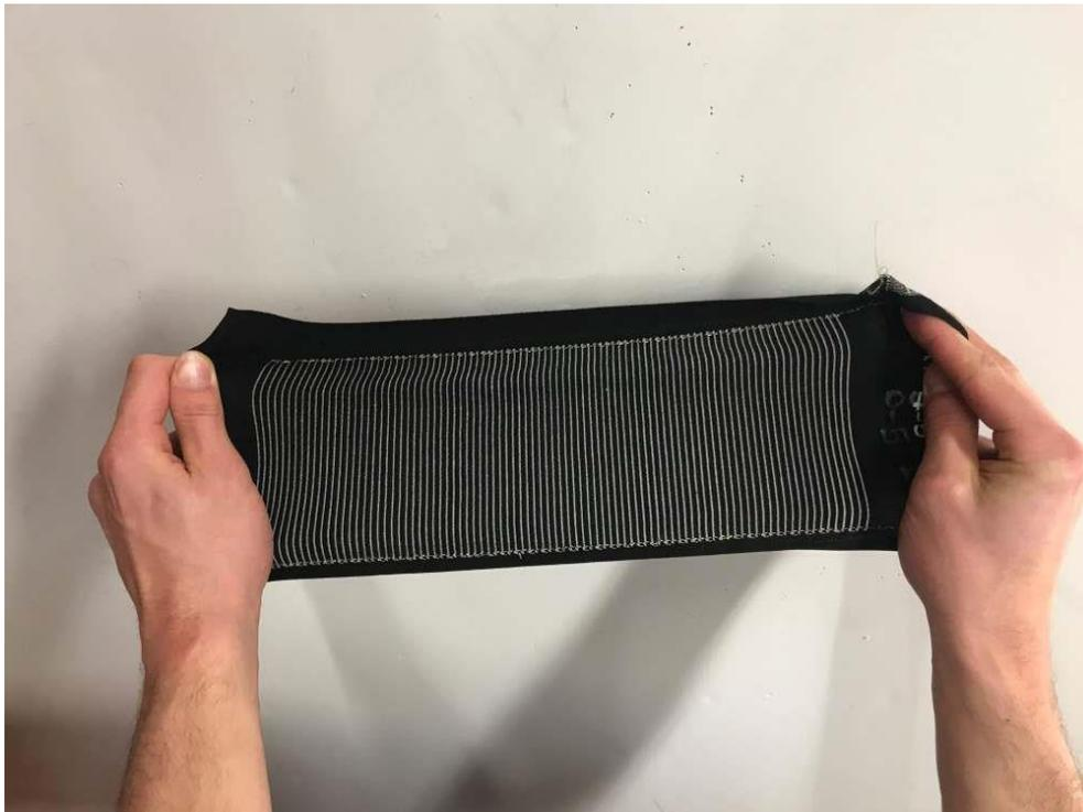
Dehnbar und stabil: Demonstrator einer Textilien Heizung. Foto: DITF
