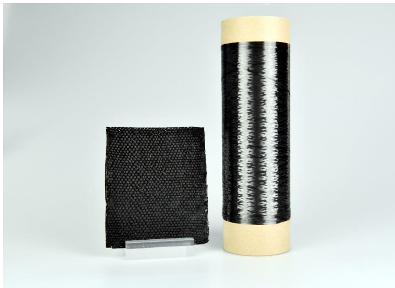
Abbildung 1 Carbonfaser aus Cellulose und Verbundwerkstoffplatte
