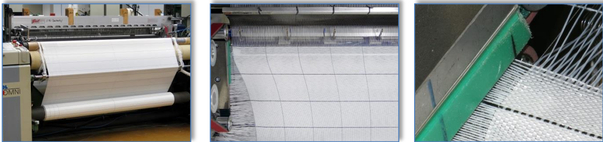
Abb.2: schussgerades Weben eines mittelschweren Gewebes mit Riemchenbreithaltern Drehzahl: 450 \text{ min}^{-1} , Flächengewicht: 224 \text{ g/m}^2 , Bindung: L 1/1, Einsprung: 5,8 %
