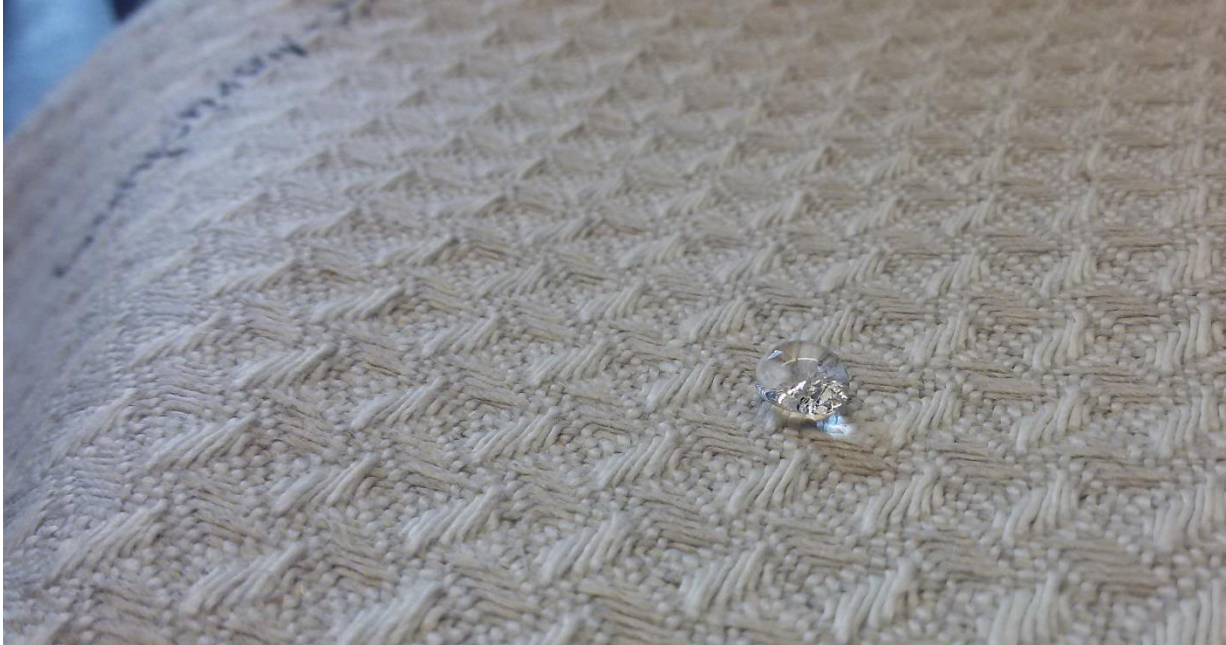
Abbildung 2: Leinengewebe mit Sperrschicht auf der linken Wareseite und hydrophober rechter Wareseite
