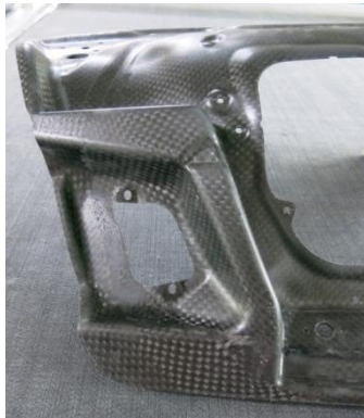
Endkontur eines carbonfaserverstärkten Heckdeckels mit integriertem Lampentopf
