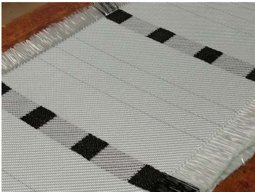
Abbildung 3: Sensorische Mehrlagengewebestruktur („Through-the-Thickness“-Anbindung mit Carbonelektroden)
