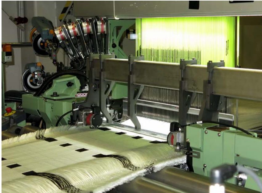
Abbildung 2: Herstellungsprozess der sensorischen Verstärkungsstruktur auf Mehrlagengewebebasis auf der Webmaschine
