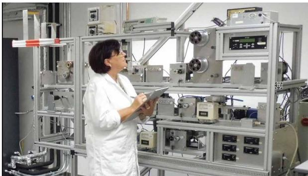
Quick-Size-Tester (Garnbeschichtung und Prüfung in einem Gerät)
