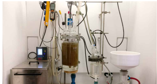
Glasreaktor für Polykondensationsreaktionen
