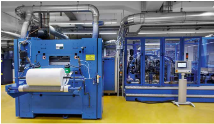
1.000 mm Nadelvliesanlage für Carbon- und Naturfaserverarbeitung
