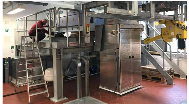
Bikomponenten-BCF-Spinnanlage der Firma Oerlikon Neumag
