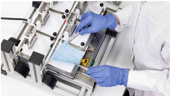
ReBa²-Prüfgerät zur Bestimmung des Keimdurchgangs
