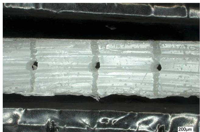
Mikrotomschnitt durch Kanäle eines additiv gefertigten kortikalen Gerüsts
