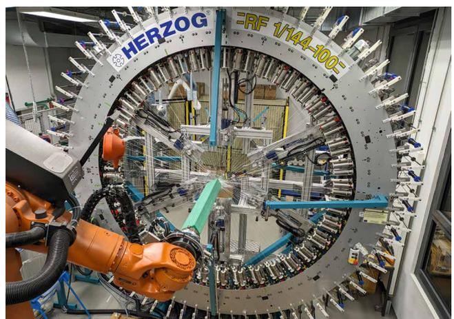
Radialflechtmaschine mit installiertem FlexiRing
