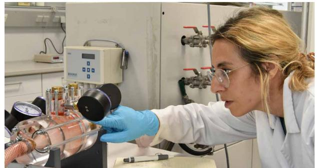
Anwendungsrelevante Filtrationsprüfungen, hier Entölung des industriellen Prozesswassers
