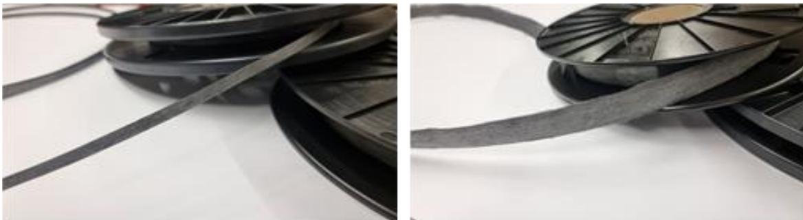
Entwickelte „Infinity“ rCF-Tape-Varianten. Links mit und rechts ohne Besäumung der Tapeanten. Foto: DITF
