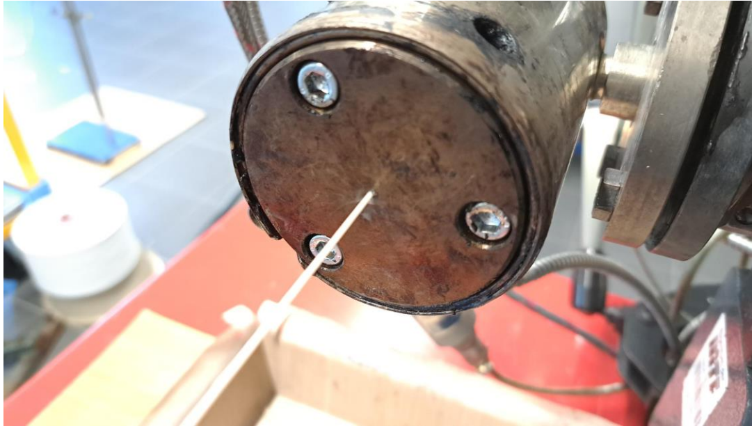
Beschichtung eines Baumwollgarns mit PHA mithilfe einer Ummantelungsdüse. Foto: DITF
