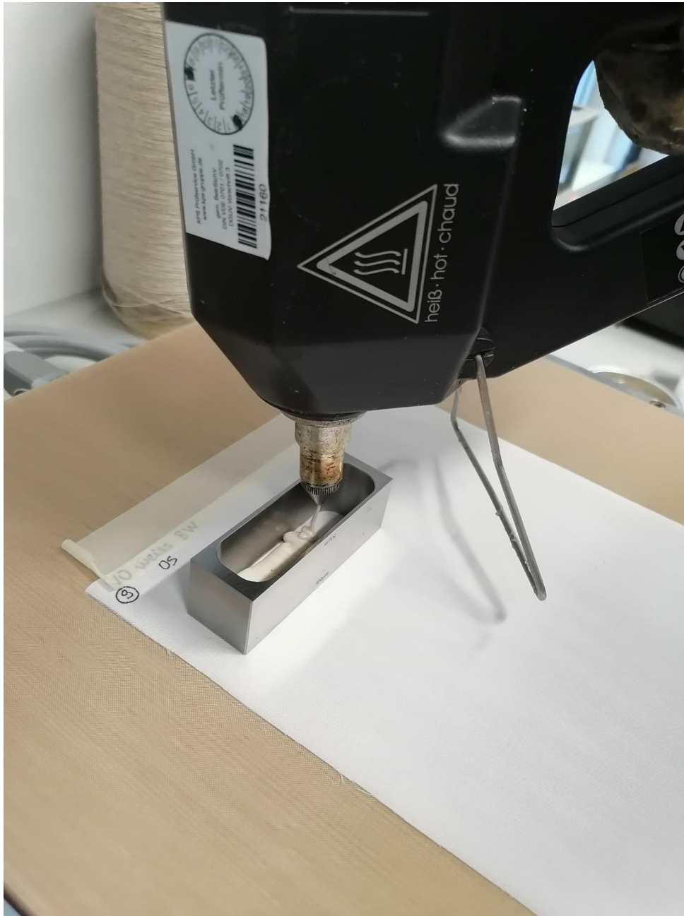
Rakelbeschichtung von geschmolzenem PHA auf ein Baumwollgewebe. Foto: DITF
